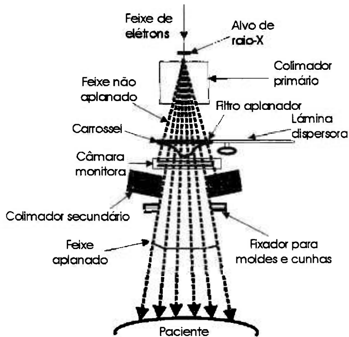
Figura 2.5.2: Cabeçote de tratamento
