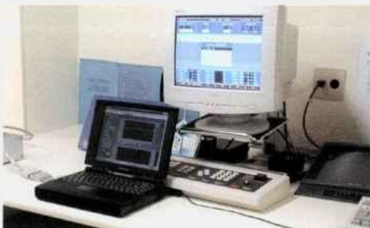
Figura 6.1.9: Monitor de controle do acelerador linear e 'notebook' do sistema dosimétrico.
